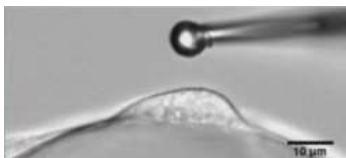
Figure 1. Image en microscopie optique d'une cellule endothéliale vue de profil et d'un microindenteur constitué d'une microfibre en verre avec à son extrémité une microbille de verre
